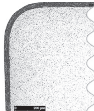
Kantenbedeckung mit VACCOAT im Schlichtbild
